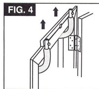
Mai întâi fixați pârghia de siguranță în paraea de sus a tocuiui ușii cu capătul îngust în jos (vezi fig. 1). Pârghia de siguranță a fost făcută în aşa fel încât să se evite căderea barei de tracțiune BODY GYM din tocuiui ușii.
